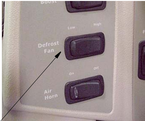
Defrost Fan Switch
