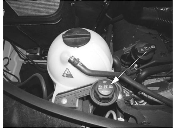
**Diesel Exhaust Fluid Fill**
