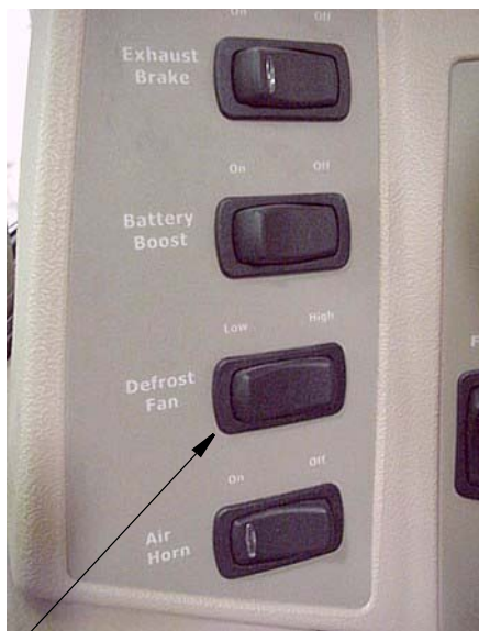
Defrost Fan Switch
